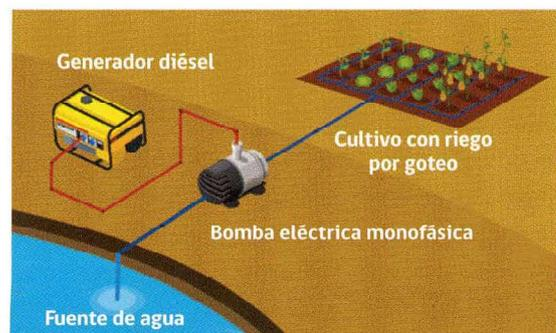
**Figura 34.** Generador Diesel alimentando con electricidad bomba en riego por goteo.
